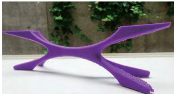
図8 このプロジェクトで一番最初に出力した3Dプリントのスケールモデル。この時は、ストラタシス社のプリンターを使用して出力
